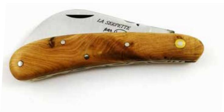
Lame d'aspect mat - Acier carbone XC 75 - Dureté de 52 HRC - Platines en laiton - Cotes fixées sur 4 points par fil inox + 1 rosette - Ressort guilloché main
